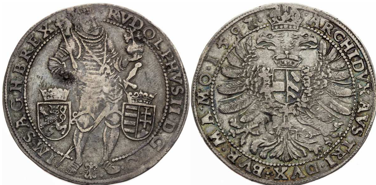
Tolar Rudolfa II. z pražské mincovny (mm. L. Ercker, zn. lilie) z r. 1592 s nehomogennou mincovního kovu v oblasti pod pravou rukou stojícího krále na líci
